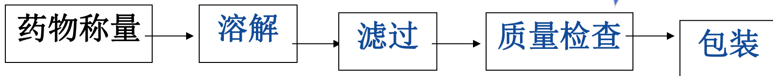
溶解法生产溶液剂工艺流程图
